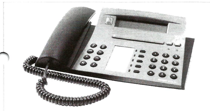
Przykładowy telefon ISDN – Ascom Eurit 33. Posiada m.in. 2-wierszowy wyświetlacz, listę 10 ostatnich połączeń, 30 nieodebranych wywołań, książkę telefoniczną na 130 wpisów i licznik opłat.
